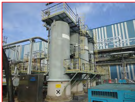
ภาพที่ 2.2-6 อุปกรณ์กำจัดปรอท (MRU)
