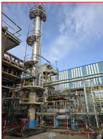
ภาพที่ 2.2-10 ระบบ Sour Water Stripping Unit (SWS1)
